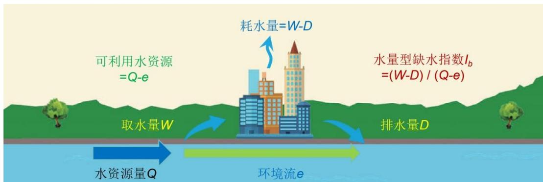
图 A1 水量型缺水核算的基本原理与过程
